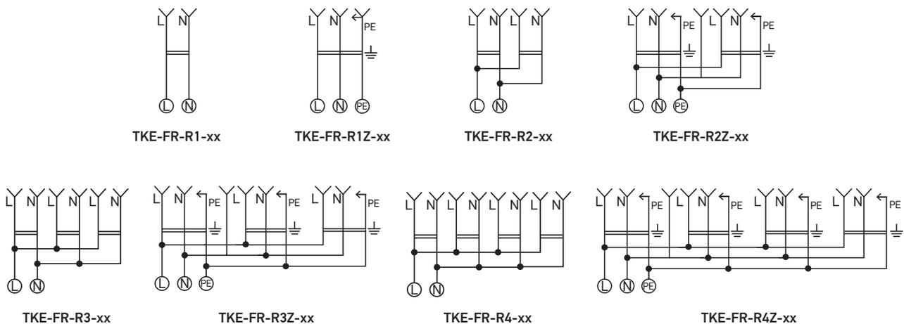
Рисунок 1. Электрические схемы розеток серии FREA (ТОКОВ™).
